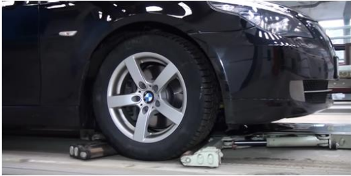
איור 4.3: ימין – המשטח מתמקם מתחת לרכב. שמאל – הצוותות "נאחזות" בצמיגי הרכב.
