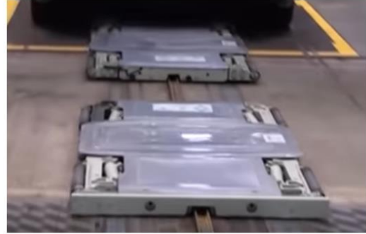
איור 4.3: ימין – המשטח מתמקם מתחת לרכב. שמאל – הצוותות "נאחזות" בצמיגי הרכב.
